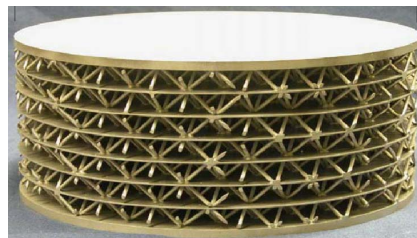
图 5 多层叠加点阵夹层结构材料 Fig.5 Multilayer superposition lattice sandwich materials
