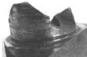
图10 源区磨损形貌
