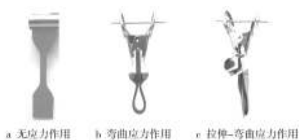
图1 加速老化过程中应力的作用方式
