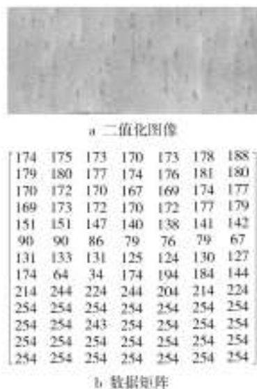
图3 腐蚀15 a试件灰度图像及其数字矩阵
