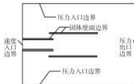
图3 计算模型及边界条件示意
