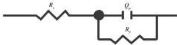
图6 不锈钢阻抗等效电路模型
