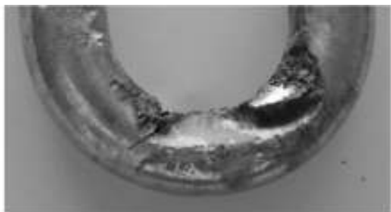
图1 不锈钢卸扣与钛框架接触部位产生电偶腐蚀
