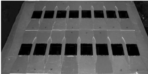
图 3 采用真空袋压法进行复合材料修理
