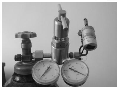
图 3 舵机气动装置加压试验
