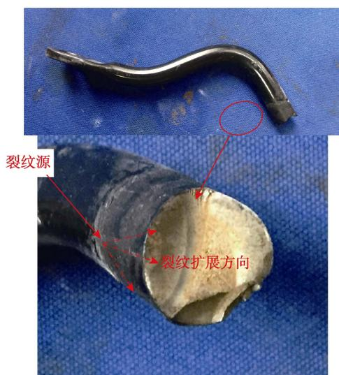
图 1 样品及断口宏观形貌
