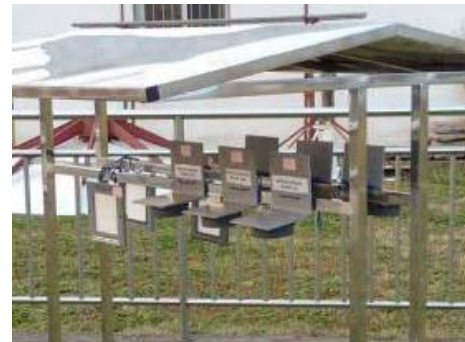
图 2 大气污染物沉降率的采集器
