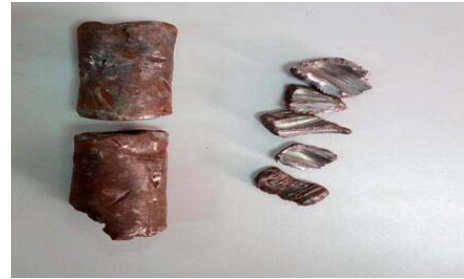
图 12 破碎机毁形试验效果 Fig.12 Effect of crusher destruction test
