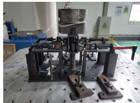
图 10 正弦扫频振动试验
