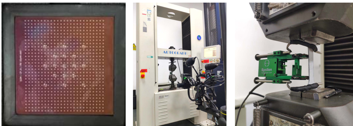
图 2 标定板及 FTS 试验测试现场
