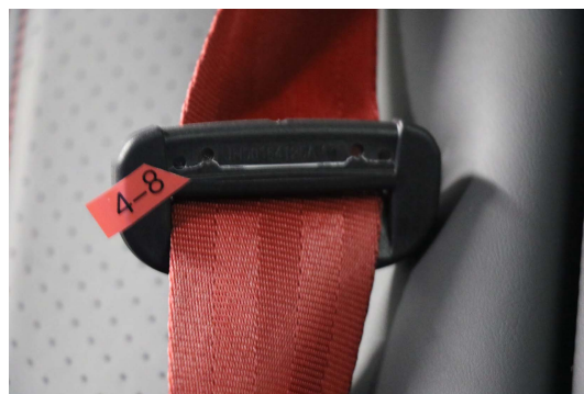
图5 安全带扣开裂
