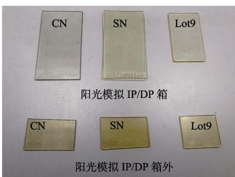
图4 阳光模拟试验后样品
