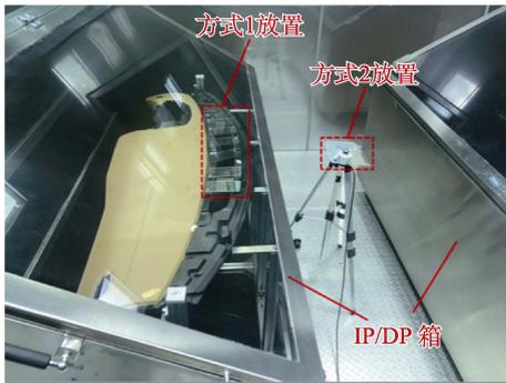
图 1 试验样品放置
