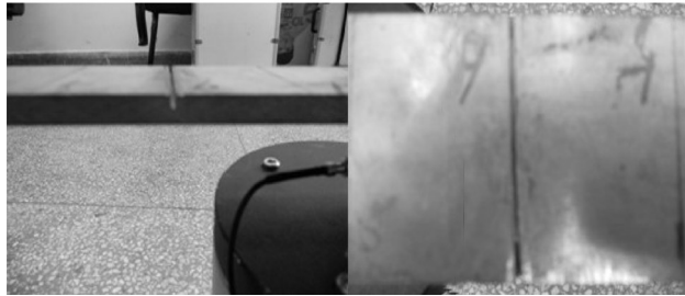
图6 梁的损伤构造
