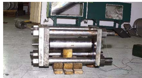
图 4 挤进台架 Fig.4 Engraving testbed
