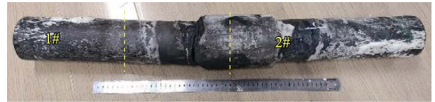
图 1 失效修复油管宏观形貌
