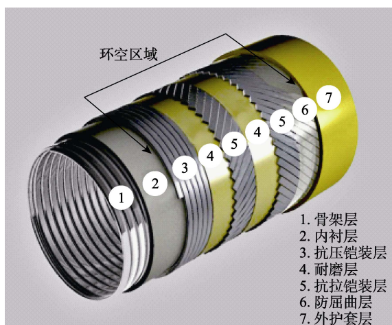
图 1 非黏结柔性立管结构 [4]
