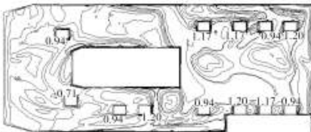
图7 舱盖开启时的气流速度(m/s)分布
