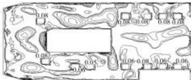
图5 车舱密闭时的气流速度(m/s)分布
