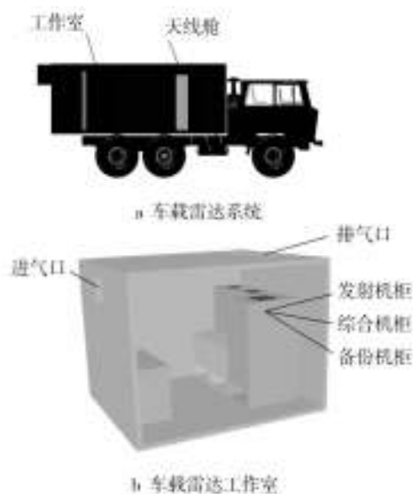
图1 车载雷达系统及车载雷达工作室布局
