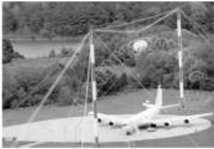
图4 飞机电磁脉冲试验
