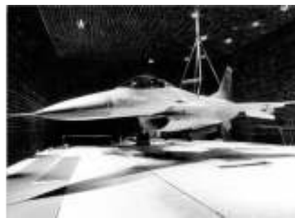
图 3 全机电波暗室测试设施
