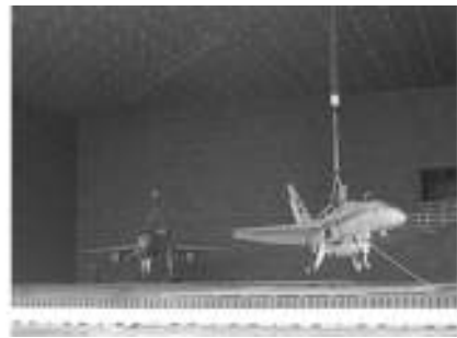
图 2 美国海军航空作战中心 E3 实验室飞机系统试验
