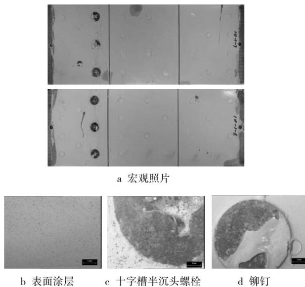
图 7 制造状态加速腐蚀 6 个周期的腐蚀情况
