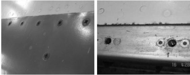
图3 蒙皮结构腐蚀情况
