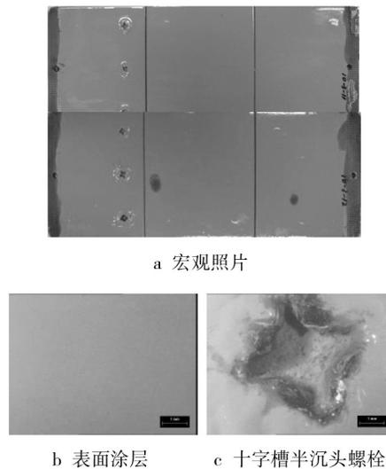
图 9 IMR21 纳米复合涂层体系加速腐蚀 6 个周期的腐蚀情况
