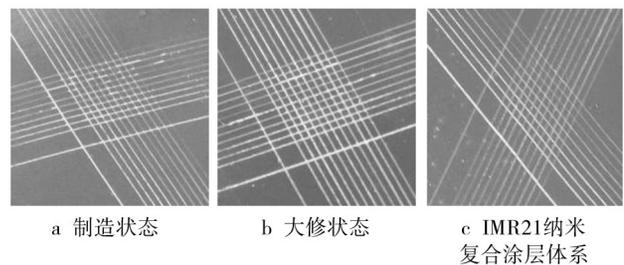
图2 涂层体系  $1 \times 1 mm$  划格实验
