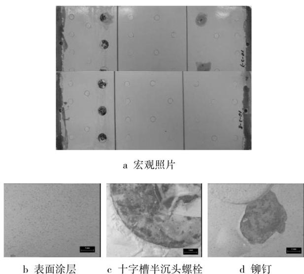
图 8 大修状态加速腐蚀 6 个周期的腐蚀情况
