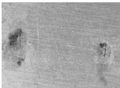
图3 腐蚀后的试件表面状况
