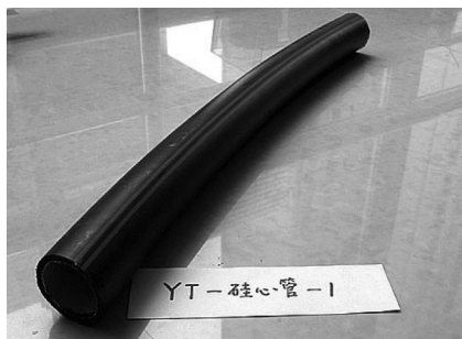
图5 各站的HDPE硅芯管基本无变化(以鹰潭站为例)
