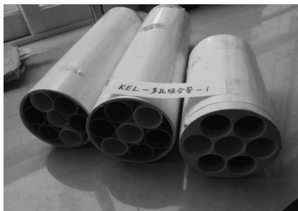
图4 库尔勒站组合多孔管埋藏1 a后形貌
