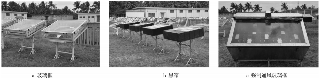
图1 试验中的自然环境加速试验装置
