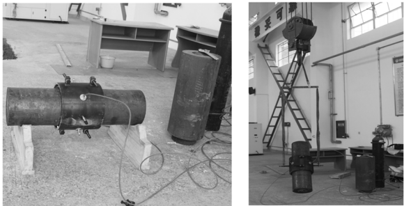
图 5 水平起吊以及翻转 Fig. 5 The horizontal lifting and turning
