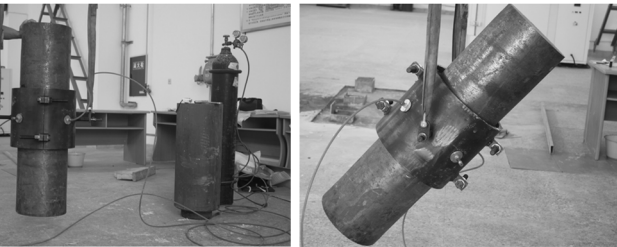
图 7 垂直起吊以及翻转 Fig. 7 The vertical lifting and turning
