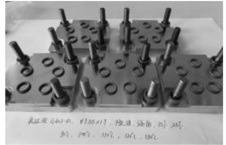
图1 O形橡胶圈加速老化试验工装
