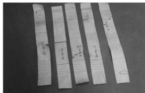
c URETEK-3216LV(热合)高湿老化后拉伸破坏形式
