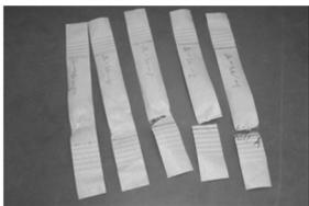
b URETEK-3216LV(本体)高湿老化后拉伸破坏形式
