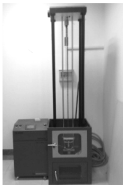
图 2 ZCJ9162 型全自动落锤冲击试验机
