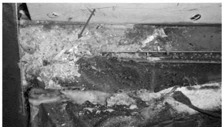
图4 机舱下部积水、隔音垫霉变和结构腐蚀
