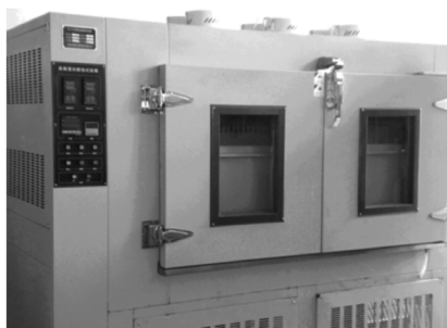
图2 ZJF-09G 周期浸润腐蚀试验箱
