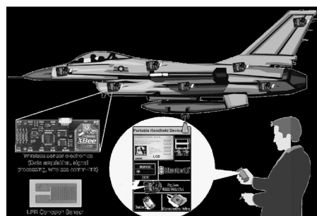
图 2 腐蚀监测系统工作模式原理
