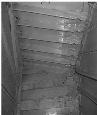
图7 缓蚀剂在军用飞机上的应用试验
