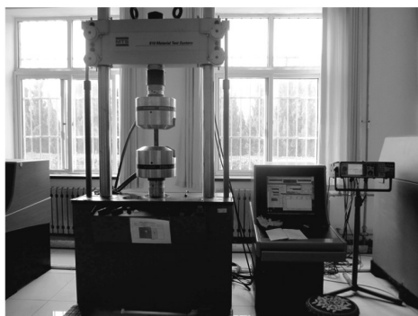
图4 MTS810疲劳试验机和测试系统 Fig.4 The MTS810 servohydraulic test frame
