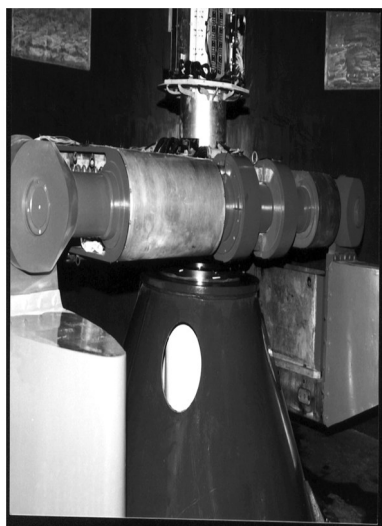
图7 西南交通大学 100g-t 土工离心机转臂结构
