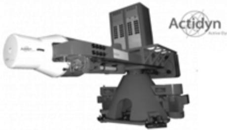
图11 Actidyn公司的离心-振动试验系统
