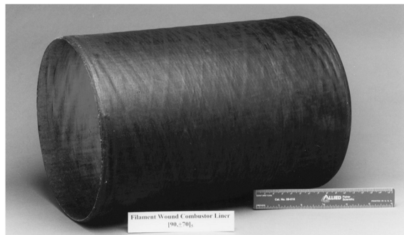
图3 Si(B)CN陶瓷基复合材料燃烧室内衬样件
