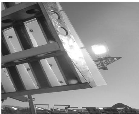
图 7 反射面、集光结构及样品区域的聚光束
