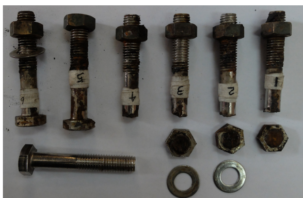
图1 断裂螺栓宏观形貌
