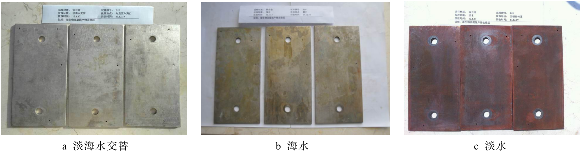
图 7 B10 暴露 2 年腐蚀产物去除后
