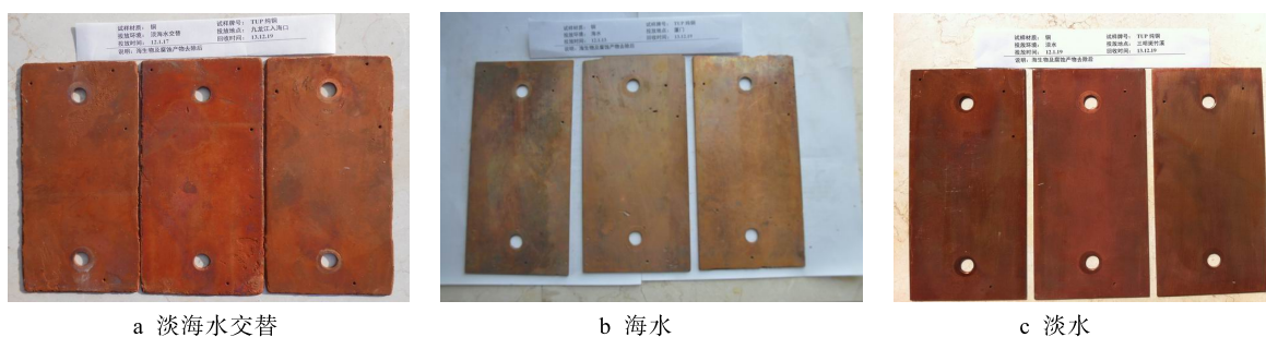
图 5 TUP 纯铜暴露 2 年腐蚀产物去除后
