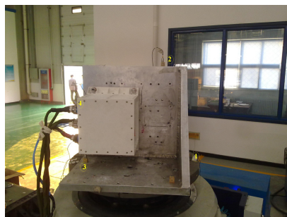
图 7 步进随机振动试验状态
