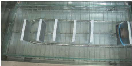
图 5 试件在溶液中的放置
