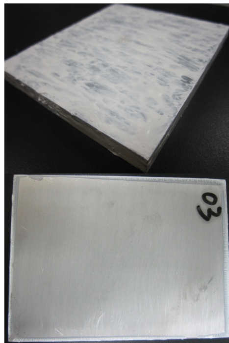
图 3 涂抹密封胶后试件
