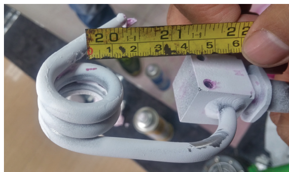
图6 压力表弹簧管两边顶部的渗透检测
