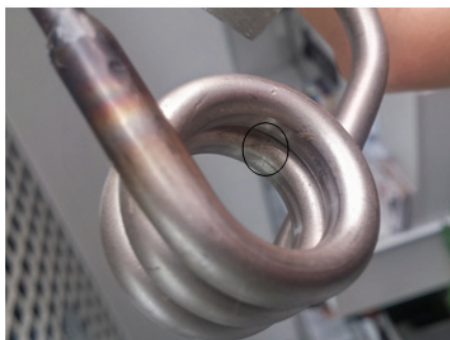
图2 圆圈弹簧管及一沟槽形貌
