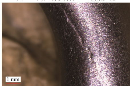
图3 圆圈弹簧管上沟槽放大形貌
