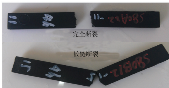
图 3 两种冲击断裂形态
