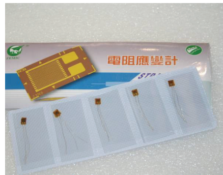
图 4 实验用应变片
