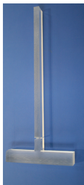
图 1 含裂纹悬臂梁试件
