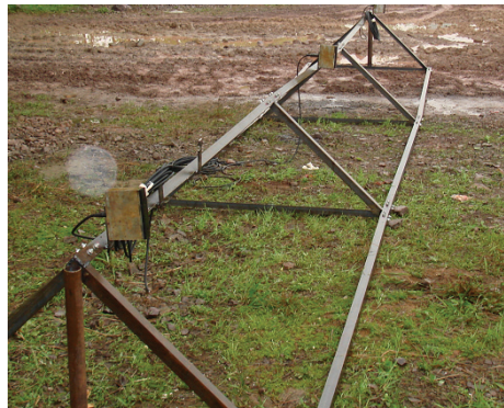
图 11 富春江实验超声发射器的固定安装
