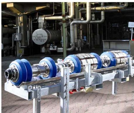
图 2 带有磁通量检测工具的智能管道“猪”
