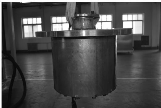
图7 环境试验后消声器外观图
