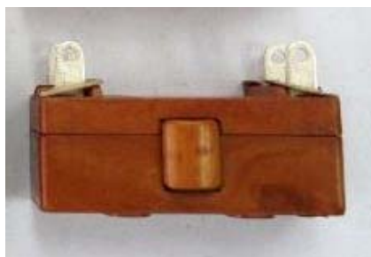
图 1 DK1-2 微动开关试验件照片
